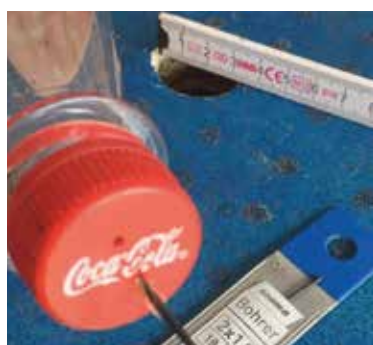
Abb.2: Zwei 1,5 mm Bohrungen im fest schließenden Deckel einer Hartplastikflasche genügen meist.
