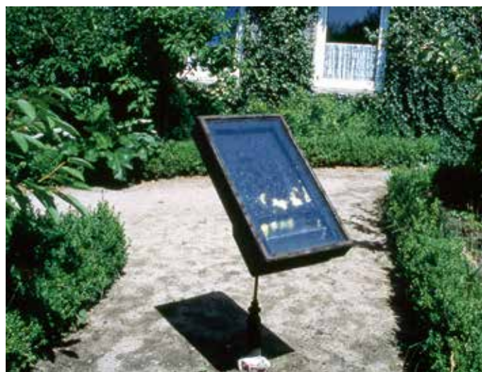
Kleinere Imkereien arbeiten häufig mit einem Sonnenwachsschmelzer
