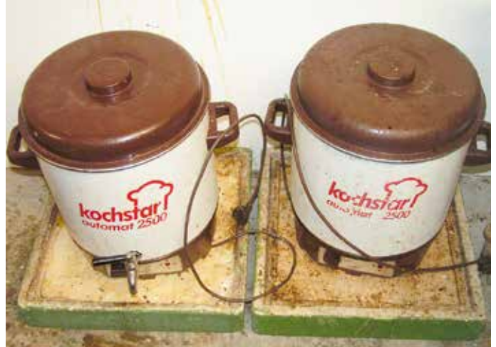
Einkochtöpfe zur Herstellung von Blockwachs
