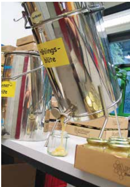
Abb.1 Kannen und Halterungen aus Edelstahl sind dauerhaft haltbar, sehr zuverlässig und gut zu reinigen. Sie sind allerdings auch teuer. Zudem muss der Honig immer wieder umgefüllt werden. Achtung: unter dem Glas fehlt eine geeichte Waage.
