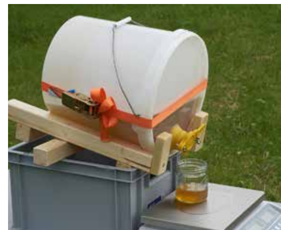
Abb.3 Ohne Umwege ins Glas: gewechselt wird hier nur der Deckel, der Honig wird direkt in den Eimer gesiebt, dann dort gelagert, abgeschäumt, gerührt und letztlich auch daraus abgefüllt.
