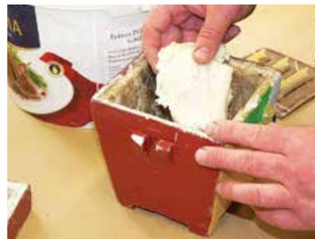
Bild 3: Befüllen mit Futterteig.
