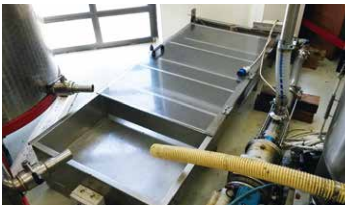
Mehrstufiges Klärbecken zur druckfreien Reinigung auch größerer Honigmengen direkt nach dem Schleudern.
